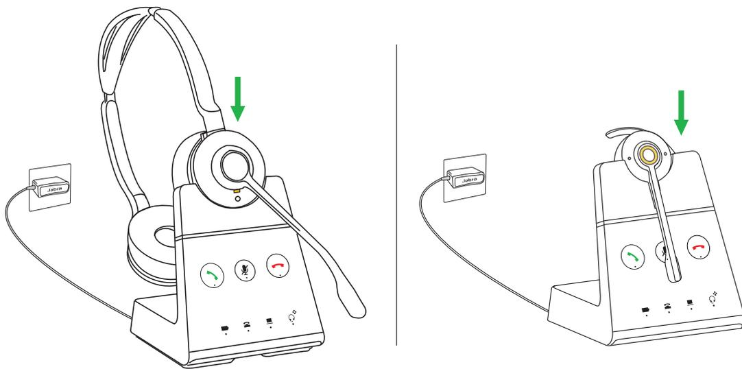
Das Headset wird stets geladen, wenn es in der Basisstation angedockt wird und diese an eine Stromversorgung angeschlossen ist. Während des Aufladens blinkt die Status-LED am Headset und das Batteriesymbol an der Basisstation.
