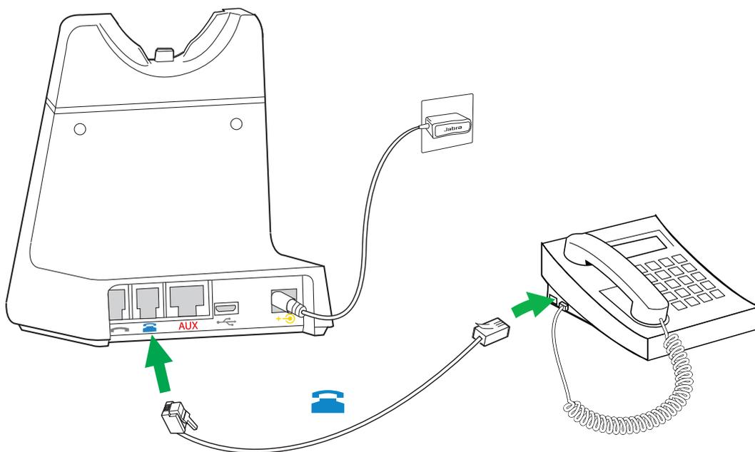
1. Verbinden Sie die mit einem
