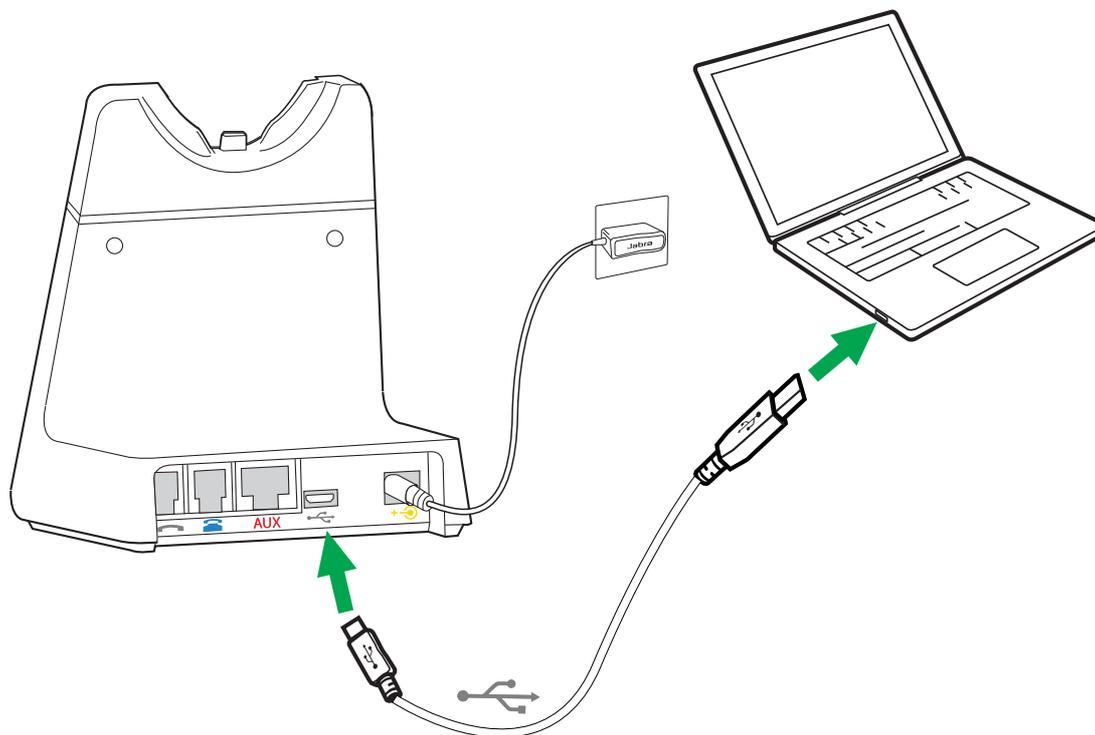
1. Verbinden Sie die mit einem
