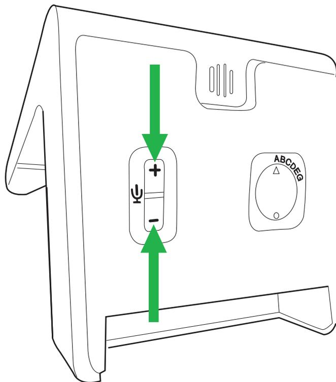
Zur Einstellung der Mikrofonlautstärke drücken Sie die Tasten  $+$  oder  $-$  auf der Unterseite der Basisstation.
