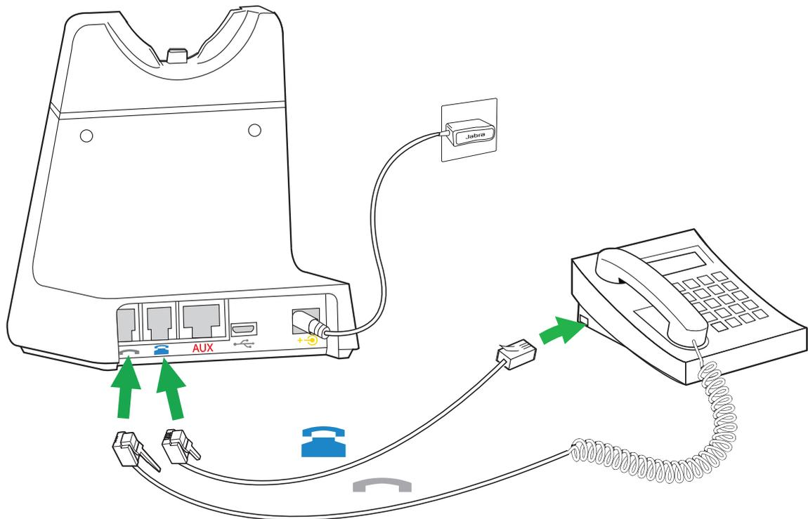
1. Ziehen Sie das Hörerkabel aus dem Höreranschluss am Tischapparat und stecken Sie es in die
