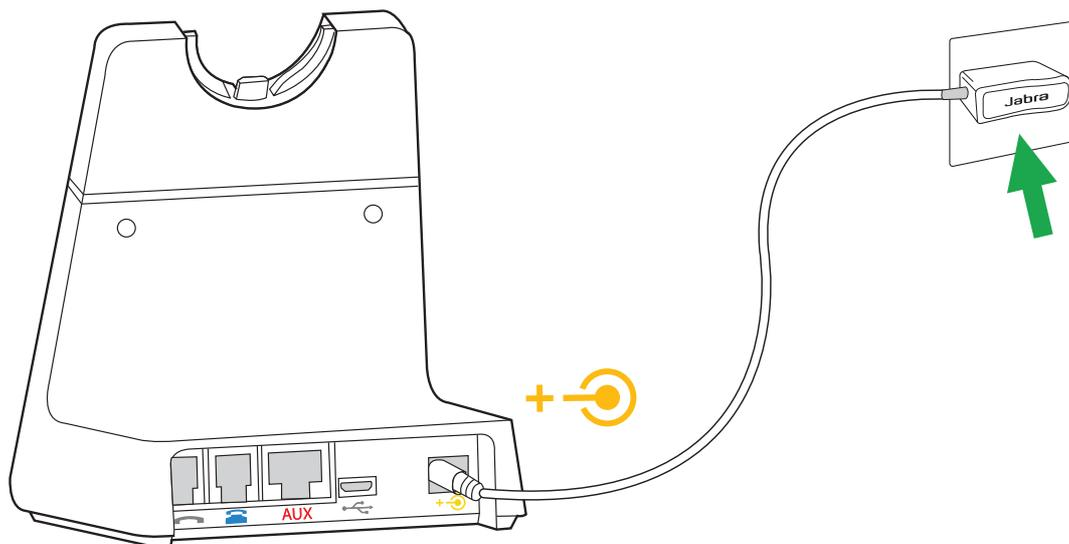
Schließen Sie die Basisstation mit dem mitgelieferten Netzkabel an einer Netzsteckdose an.
