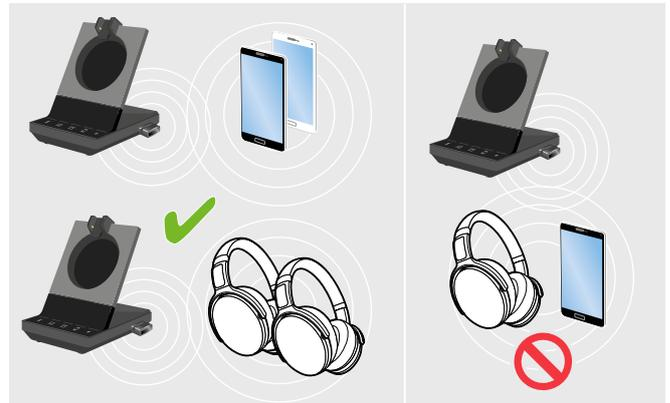
Beim Einschalten versucht der Dongle automatisch, sich mit den beiden zuletzt verwendeten Bluetooth-Geräten zu verbinden – Mobiltelefon und Headset können nicht kombiniert werden. Das Verbinden eines dritten Bluetooth-Geräts ist erst möglich, nachdem Sie das erste oder zweite Bluetooth-Gerät ausgeschaltet haben.
