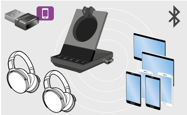
Der Dongle kann bis zu acht gekoppelte Bluetooth-Geräte speichern. Beim Koppeln eines neunten Geräts, wird das Verbindungsprofil des am wenigsten genutzten Bluetooth-Geräts überschrieben. Um dieses Gerät später wieder zu verwenden, koppeln Sie dieses erneut.
