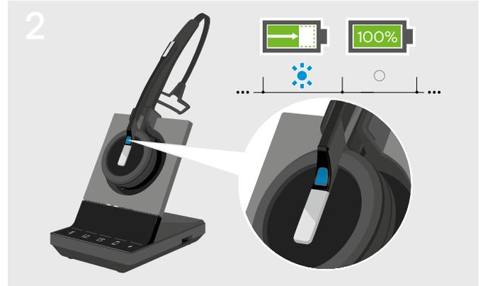
▶ Legen Sie das Headset in die Magnethalterung der Basisstation. Die Headset-Akku-LEDs der Basisstation zeigen den Ladezustand an.
