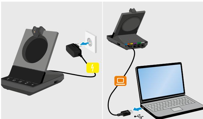
▷ Trennen Sie die Basisstation vom Stromnetz sowie vom Computer.
